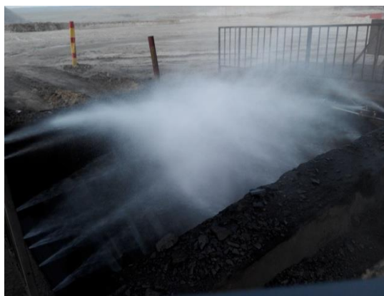
原煤落料口降尘
